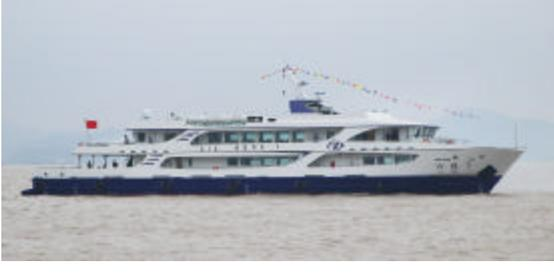
□通讯员 刘生国 文/摄 沈家门航线的运营。 “六横1”客轮长49.35米、宽8.5米、净深3.4米,航速17节,抗风等级9级。六横至沈家门航线航程约55分钟。该客轮共有323个客位,设上中下3个客舱以及3个接待室。客舱座位间隔大,通道宽敞,有无线信号和手机充电接口。此外,客舱各层甲板共设有6个洗手间,力争为旅客出行创造舒适便捷的旅途环境。
