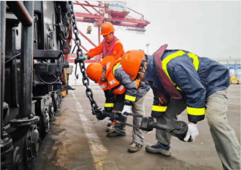
面对寒潮大风来袭,舟山港综合保税区码头有限公司的门机司机们随“风”而动,迎“寒”而上,合力为门机设备安装防风拉锁,保障码头设备安全稳固
