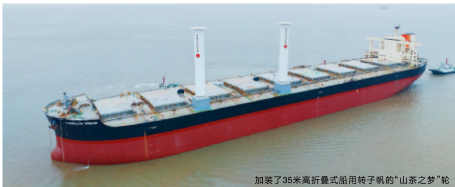
加装了35米高折叠式船用转子帆的“山茶之梦”轮
