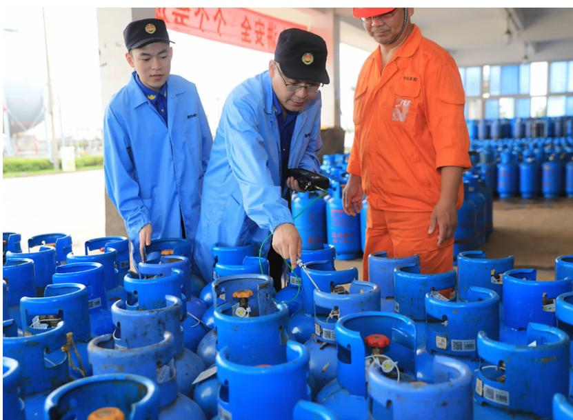
昨天，市城管局组织执法人员来到新城蓝焰双阳燃气场站开展城市运行领域安全生产大排查大整治专项检查。当天，执法人员用便携式可燃气体探测仪逐个对燃气罐等设施进行检测，重点针对燃气场站内设施设备运行、安全管理制度落实执行等情况进行隐患排查。
