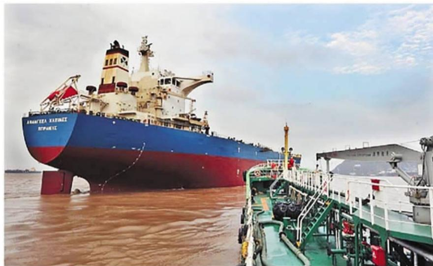
夏日夜晚，舟山港域虾峙门外锚地灯火通明，在1号锚位，一艘来自利比里亚的油化船“奇迹”轮在加注600吨保税低硫燃油。整个加油过程，无须人员上下，无接触供油，进出港手续简单高效。9个小时后，加完油的船舶办妥手续后离港。
